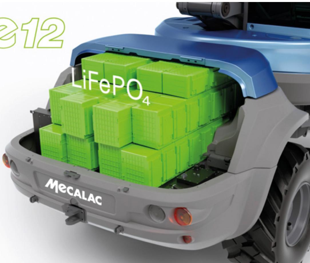
einsatzfähig: Ohne die Batterien aufzuladen kann er bei einer achtstündigen Laufzeit im optimalen Leistungsbereich arbeiten.
