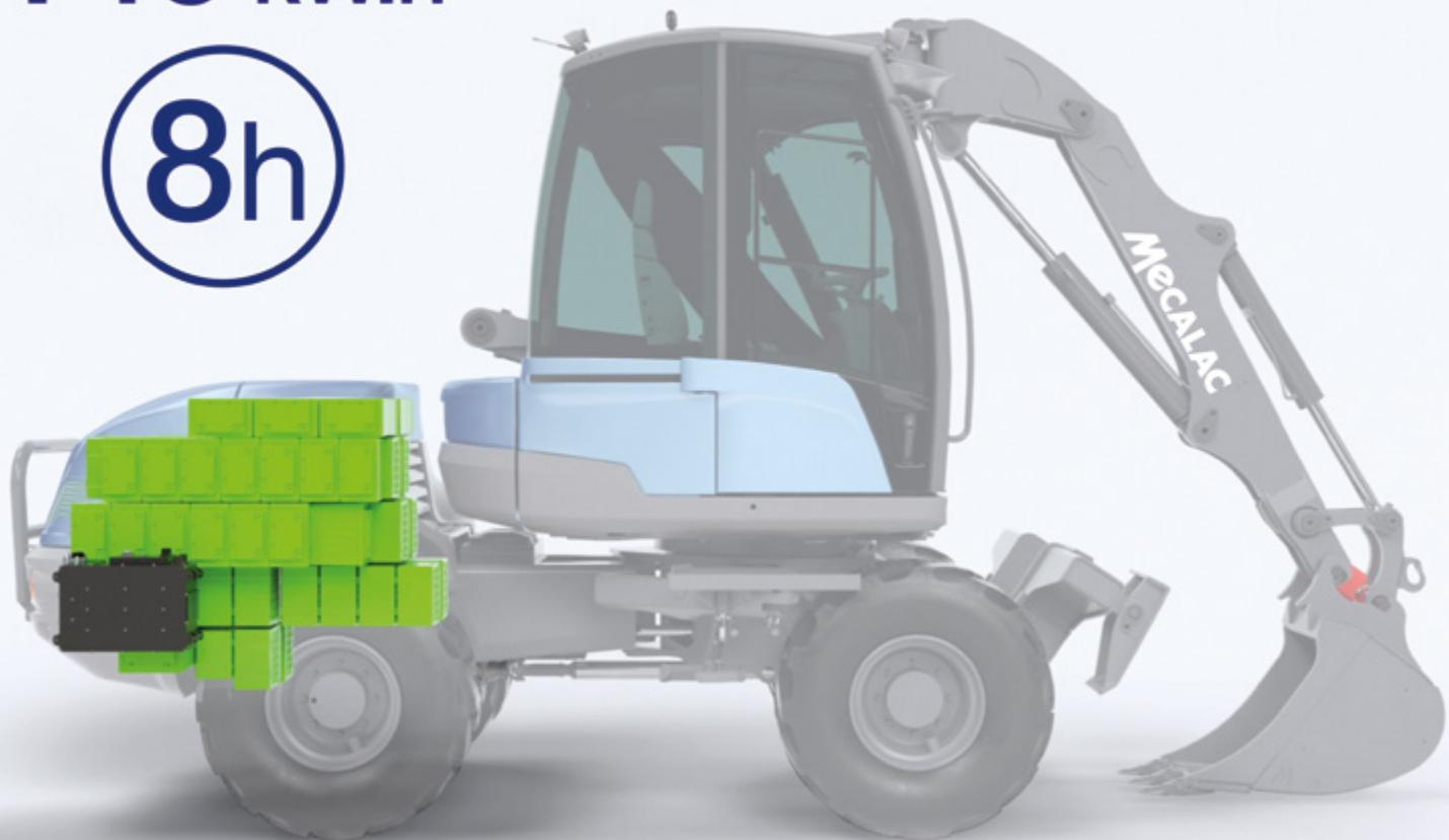
compacté et ne nécessite en outre aucun entretien. Par ailleurs, la e12 dispose d'un coffret électrique qui permet de la recharger sur place en 6 à 7 heures. Ainsi, sans compromis sur sa puissance, la e12 accomplit sa mission sur la totalité de la journée sans avoir à recharger ses batteries, 8 heures d'autonomie au meilleur régime de puissance.
